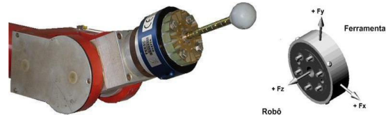
Figura 2. Sensor de força e o efetuador final.
